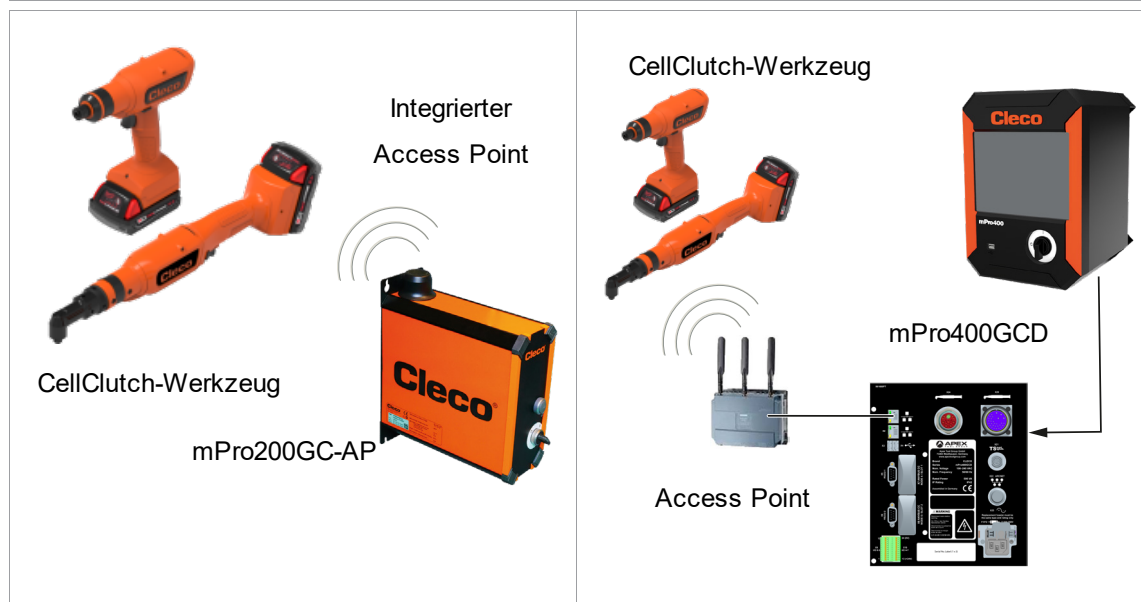
Abb. 2-1: Systemaufbau mit mPro200GC-AP
