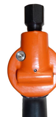
Zwykły układ wyłączający narzędzie ze wskazaniem sygnału powietrza do użytku z systemem eliminacji błędów TVP Cleco
