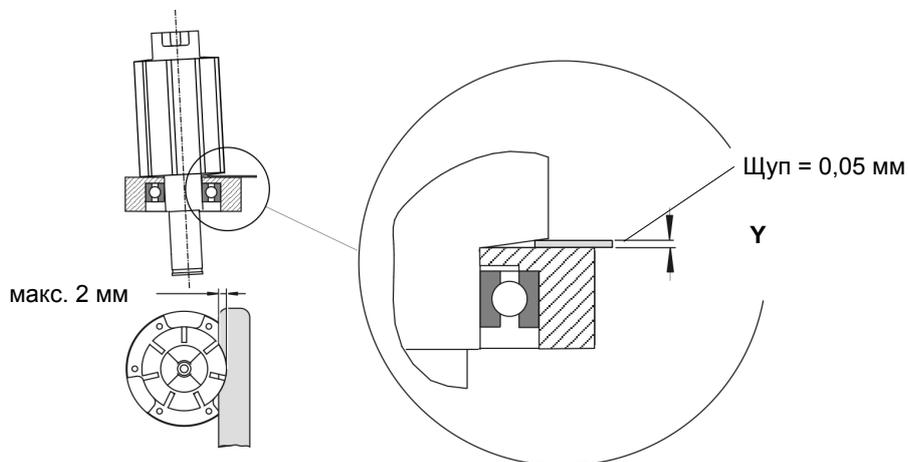
2. Проверить Y с помощью щупа. Если размер > Y, повторить шаг 1. с накладкой <C5>, <C6>, <C7>.
