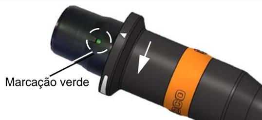
2. Conectar o cabo da ferramenta no punho da parafusadeira.
