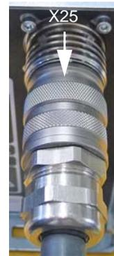
5. Para a fixação da conexão com forças externas, como vibrações, choques ou movimentos rotacionais, montar a fixação do cabo da parafusadeira (nº de referência S800556) como espaçador. A abertura da trava é prevenida.
