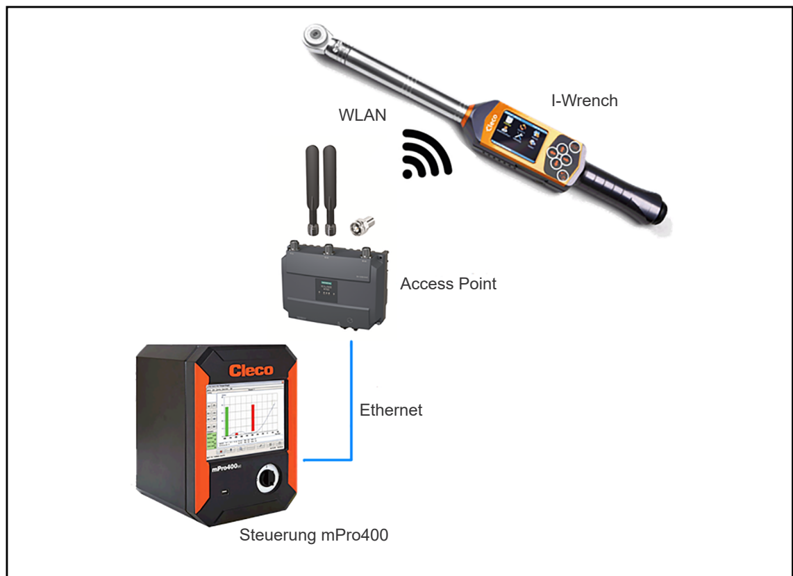
Abb. 8-1: Kommunikation zwischen I-Wrench und Steuerung
